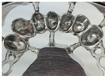
NEM-Teleskop-Primärkronen und NEM-Sekundärkonstruktion CAD/CAM-gefräst.
